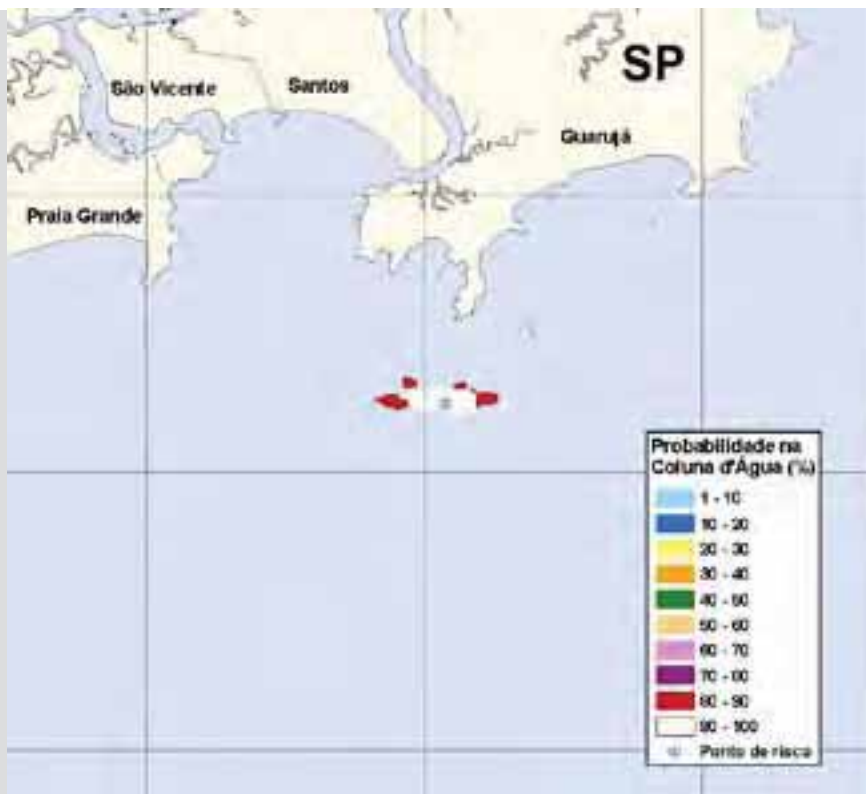
Figura 1 - Cenário GUARUJÁ_MONOBOIA_ETANOL_FUNDO_VERAO: Contornos de probabilidade do etanol na coluna d'água para o cenário de vazamento devido a ruptura da tubulação subaquática de 30", durante o período de verão, com derrame de 415,17 m 3 (ao longo de 5 minutos), após 60 horas de simulação.
