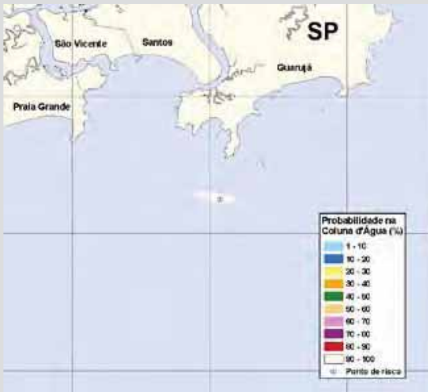
Figura 2 - Cenário GUARUJÁ_MONOBOIA_ETANOL_SUPERFICIE_VERAO: Contornos de probabilidade do etanol na coluna d'água para o cenário de vazamento devido a ruptura do magote flexível, durante o período de verão, com derrame de 502,60 m 3 (ao longo de 6 minutos), após 60 horas de simulação.
